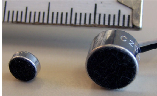
Abbildung 2.2. – MINIATUR-MIKROFONKAPSELN: WM-64MNT von Panasonic mit 0,6 cm Durchmesser (links), EMY-62NL101 von Ekulit mit 1 cm Durchmesser (rechts).
